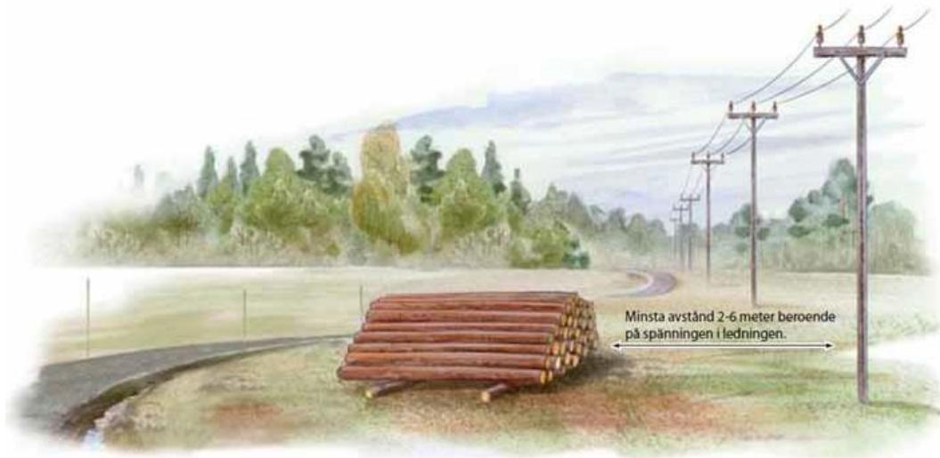
Bild som visar det horisontella avståndet mellan en vältas och lodlinjen från en luftledning.
